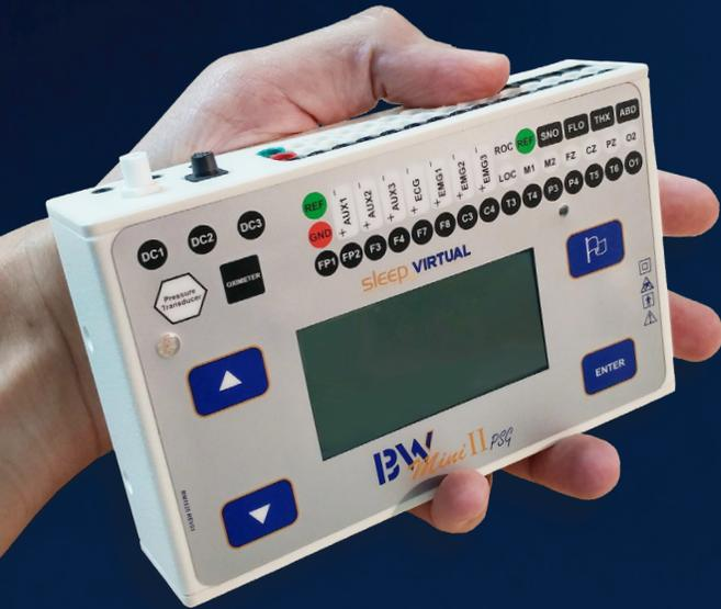
O **BWM Mini PSG** é projetado para PSG Tipo I, II, III, IV e EEG Ambulatorial (Holter EEG) – 42 canais
